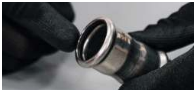
Рис. 30. Проверка уплотнительного кольца.
